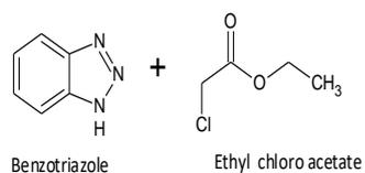
$K_2CO_3 / C_2H_5OH$  reflux 6 hours
